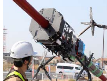
【斜張橋ケーブル点検ロボット】
