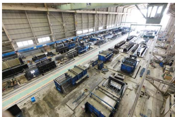
茨城工場でのプレキャスト部材製作の様子
