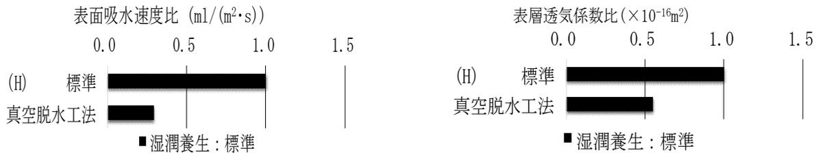
図-5 真空脱水工法が表層品質に及ぼす影響
