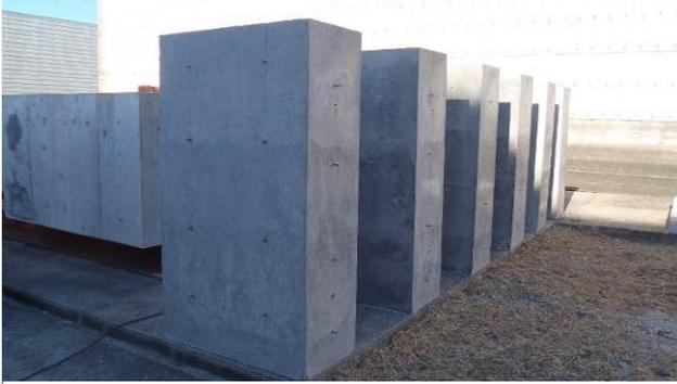
写真-1 壁試験体
