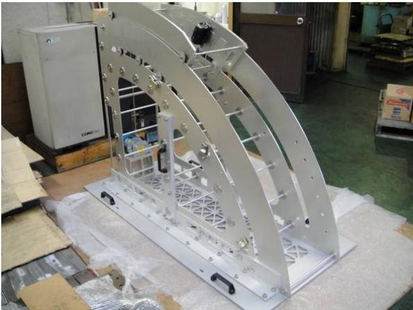
写真-5 スライド式車載撮影装置
