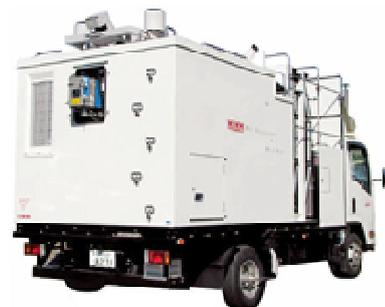
写真-1 走行型計測システム【MIMM】<sup>2)</sup>
