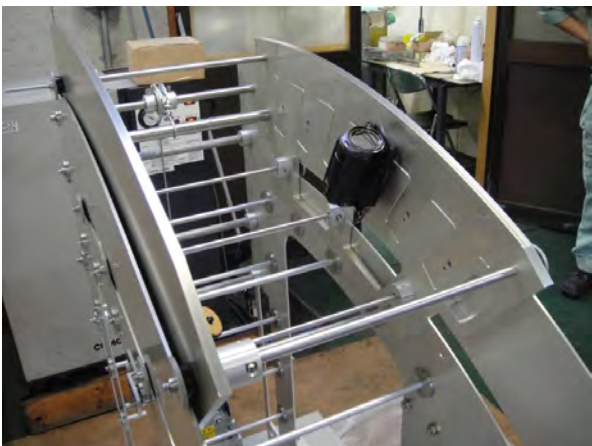
写真-6 ビデオカメラ固定用の溝
