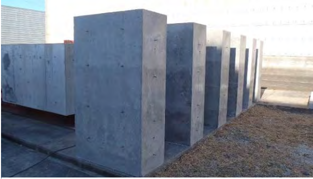
写真-1 壁試験体
