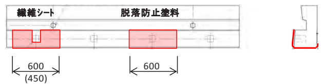
図-2 アラミド繊維シート貼り, 剥落防止塗料範囲
