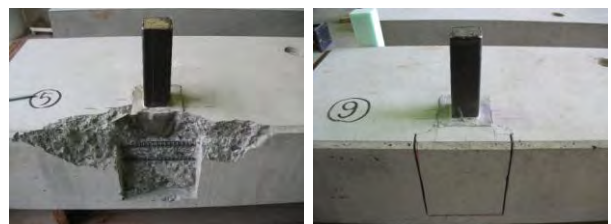
写真-1 断面欠損状況
