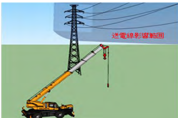
図-2 送電線近接工事の概念
