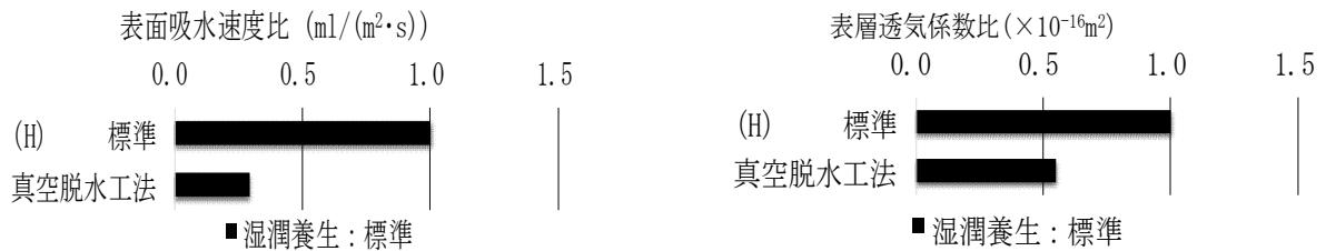
図-5 真空脱水工法が表層品質に及ぼす影響
