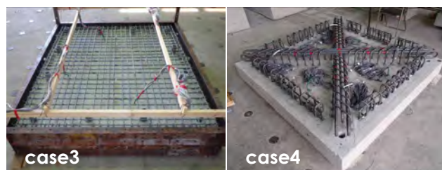
写真-1 補強状況
