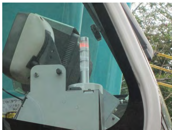
写真-3 運転席に設置したLED積層信号灯
