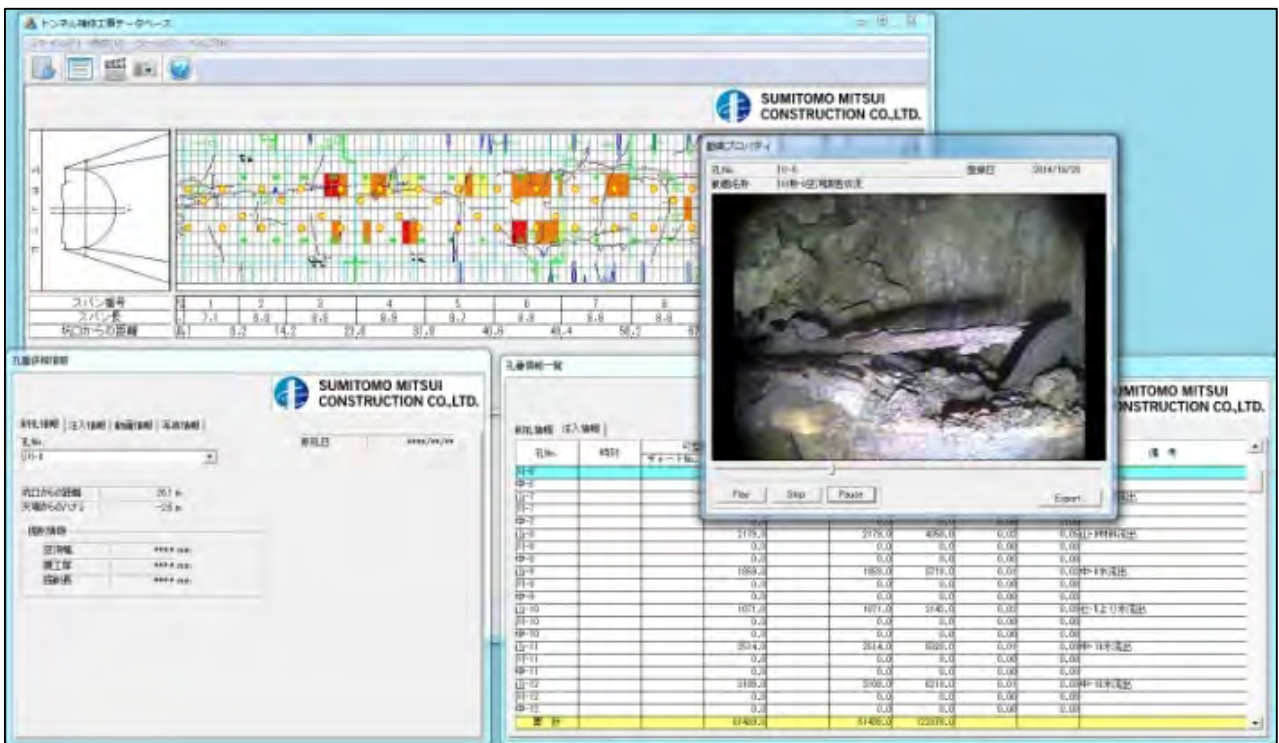
図-8 覆工背面空洞状況の動画検索
