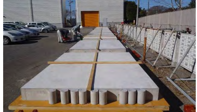
写真-2 床版試験体
