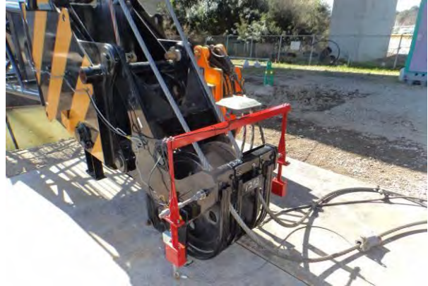
写真-1 ブーム頂点への機器設置状況 (有線方式)
