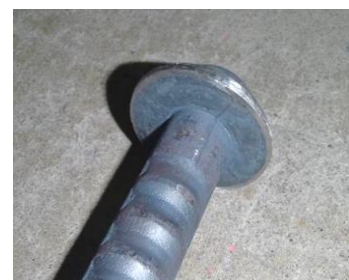
写真-1 Trunc-head (端部拡径鉄筋)
