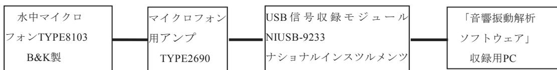
図-2 音圧レベルの計測システム
