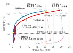
図-10 荷重と変位の関係(曲げ試験)
