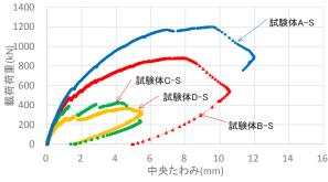
図-11 荷重と変位の関係(せん断試験)
