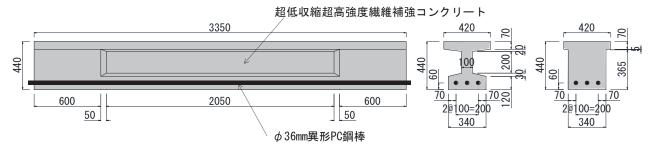
図-3 RC 梁試験体
