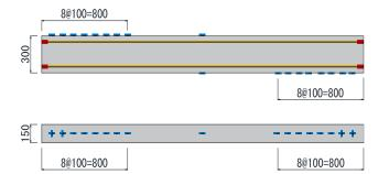
図-4 プレストレス導入時のひずみ計測位置図
