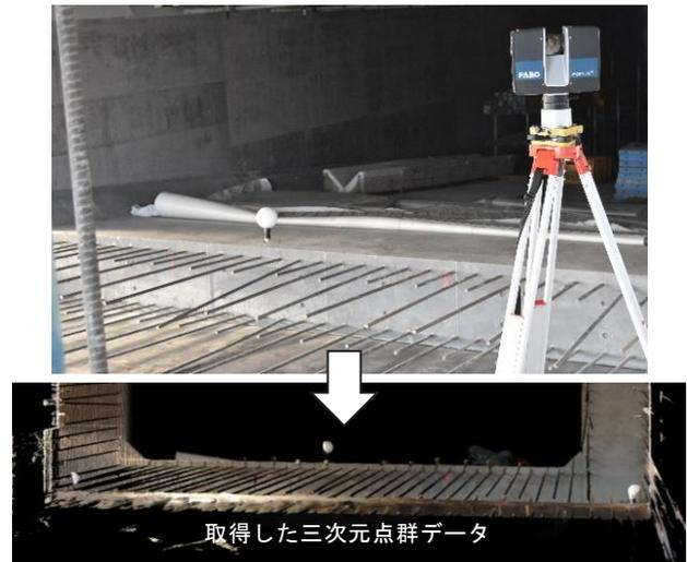
図-2 レーザースキャナーによる取得
