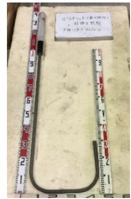
写真-5 GFRP ロッド 曲げ成形部試験体
