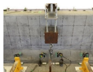
写真-2 STEP3 損傷状況 (中央載荷)
