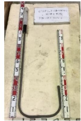
写真-5 GFRP ロッド 曲げ成形部試験体
