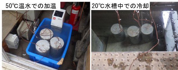
写真-1 熱伝導率試験状況
