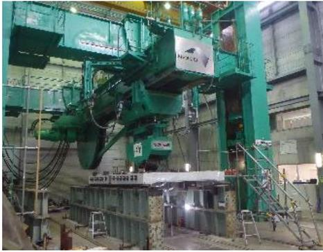
写真-3 輪荷重走行試験機
