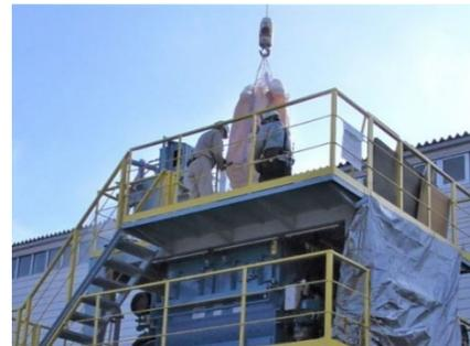
写真-4 フレコンバックに梱包した原料の投入状況
