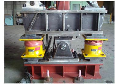
写真-2 シーソー部材と制振ダンパー
