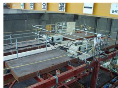
写真-3 起振機設置状況
