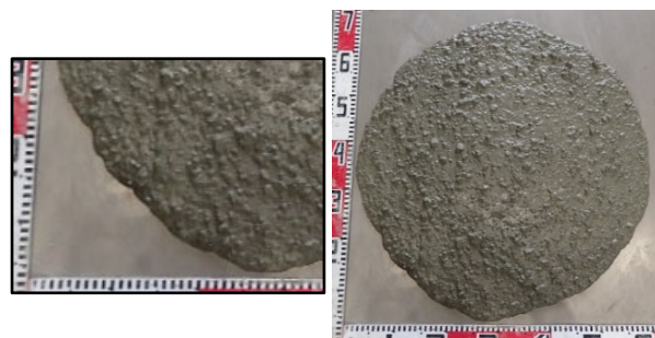
写真-2 H-CON スランプフローの様子
