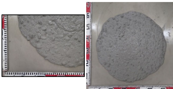
写真-1 STC-RDC スランプフローの様子
