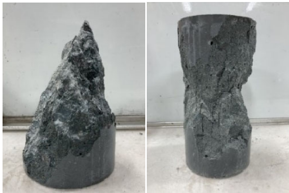
写真-3 STC-RDC 圧縮強度試験後の供試体
