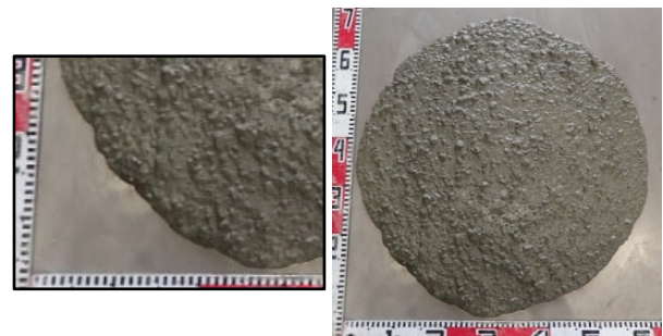
写真-2 H-CON スランプフローの様子
