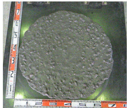
写真-2 スランプフローの一例
