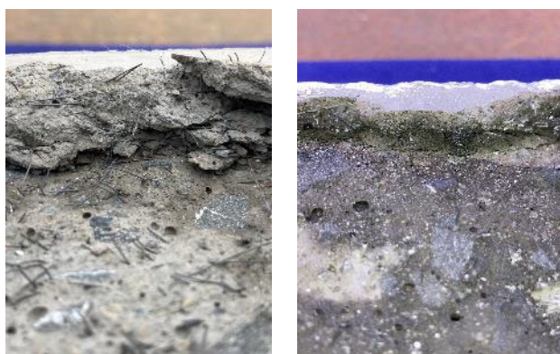
写真-2 爆裂試験後の供試体
