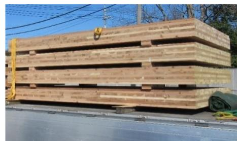
写真-1 CLT パネル
