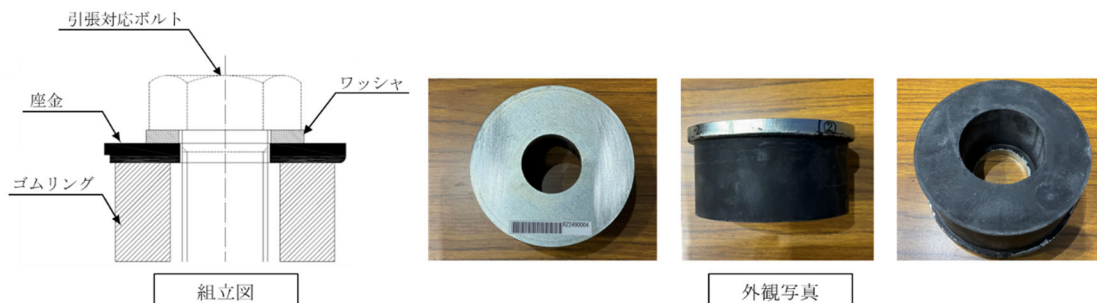
図-2 引張対応ゴムワッシャの構成
