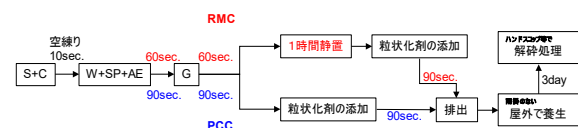
図-1 練混ぜおよび粒状化剤の添加方法
