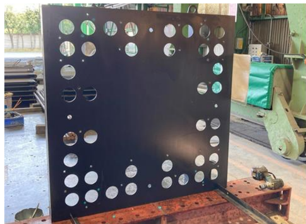
写真-1 鋼製型枠
