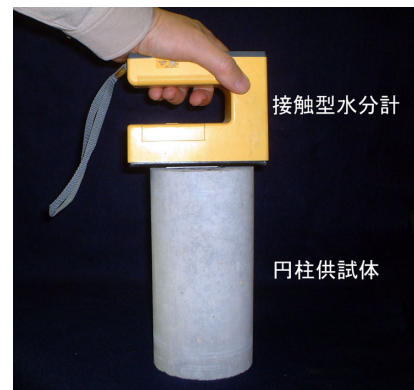
写真-1 円柱供試体の含水率測定方法
