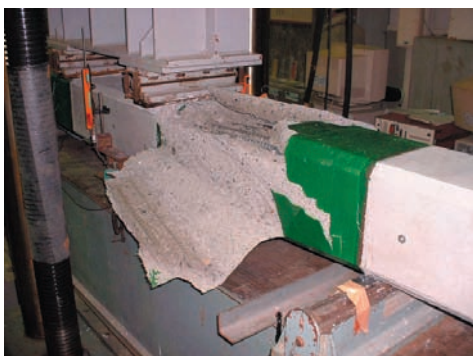
U 字+部分閉合補強の破壊状況
