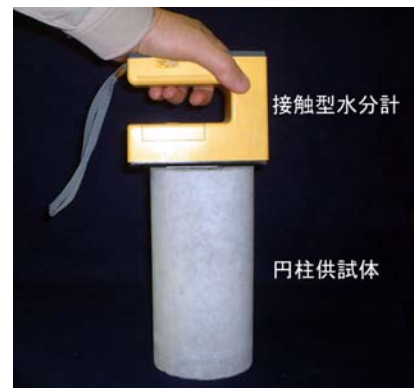
写真-1 円柱供試体の含水率測定方法
