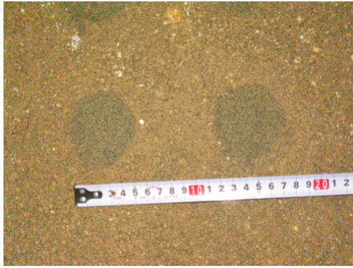
写真-2 模型杭の状況（地中）
