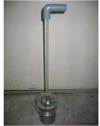
図-15 現位置変水位透水試験 写真-2 簡易現場透水試験器
