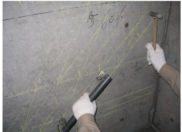
写真-1 測定角度が45度の測定状況
