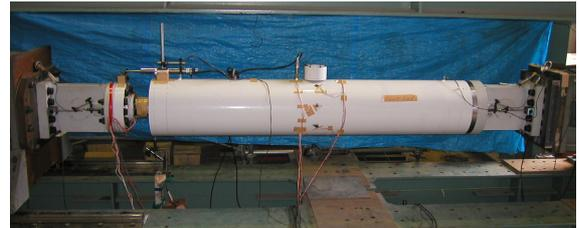
写真-1 圧縮・引張試験状況(TYPE2)
