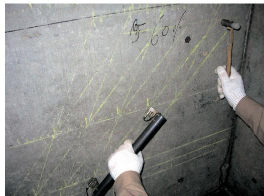
減少し、図に示すように、測定角度が45度の場合は鉄筋の影響が比較的小さくなった。したがって、45度の測定角度により鉄筋の影響をかなり排除できるものと思われる。
