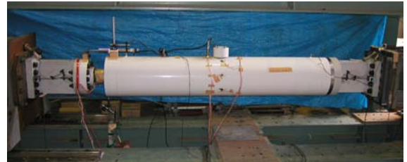
写真-1 圧縮・引張試験状況(TYPE2)
