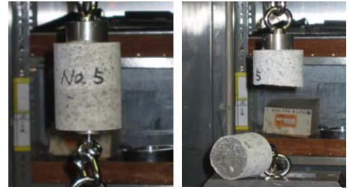
写真-9 付着強度試験状況
