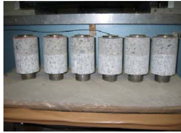
写真-8 付着強度試験供試体
