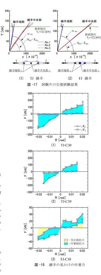
張試験結果をもとに支圧抵抗力 $F_1$ を求め、見かけの付着力 $F_1$ と支圧抵抗力 $F_1$ の差分から付着抵抗力 $F_2$ を求めた。
