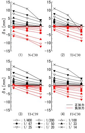
図-13 梁主筋のすべり量
