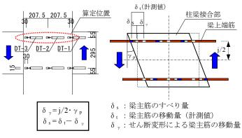
図-12 梁主筋のすべり量の算定方法
