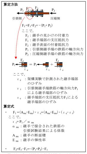
図-16 支圧抵抗力と付着抵抗力の分離方法
