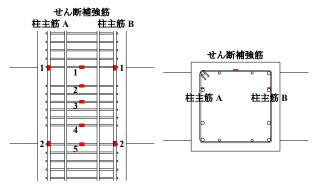
図-6 ひずみの計測位置
