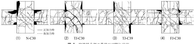
図-8 柱梁接合部の最終ひび割れ状況
