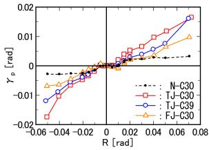
図-9 柱梁接合部せん断変形角の推移
