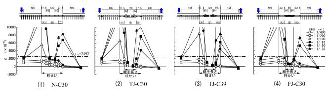
図-11 梁主筋のひずみ分布
