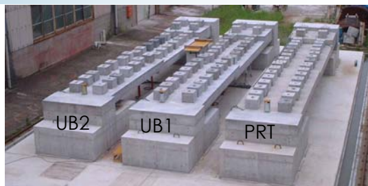
写真-1 実大試験体の载荷状況
