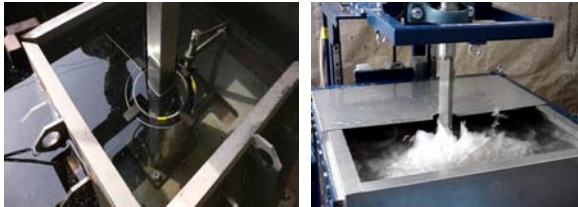
写真-2 試験体セット状況 写真-3 水中切断状況
