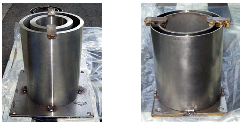
圧力管上部延長管 SUSモデル 写真-4 2重管模擬材 圧力管・カランドリア管 Zrモデル
