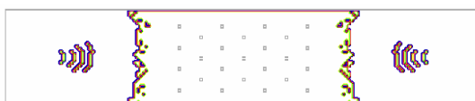
C.爆破による供試体表面の損傷領域 RC 梁爆破解体実験の数値シミュレーション例
