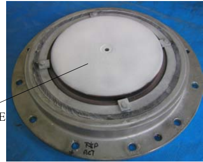
写真-2 中間プレート PTFE 塗布状況
