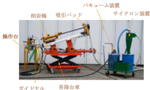
写真-2 削孔システムの構成
