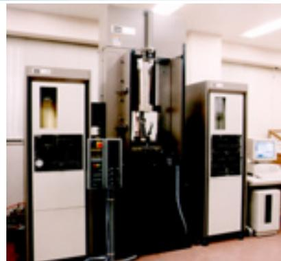
写真-1 三軸試験装置
