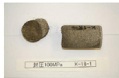
写真-3 破壊後の岩石供試体状況
