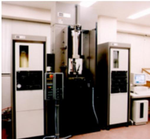
写真-2 三軸試験装置
