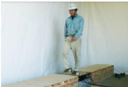
写真-1 歩行加振力の実測状況
