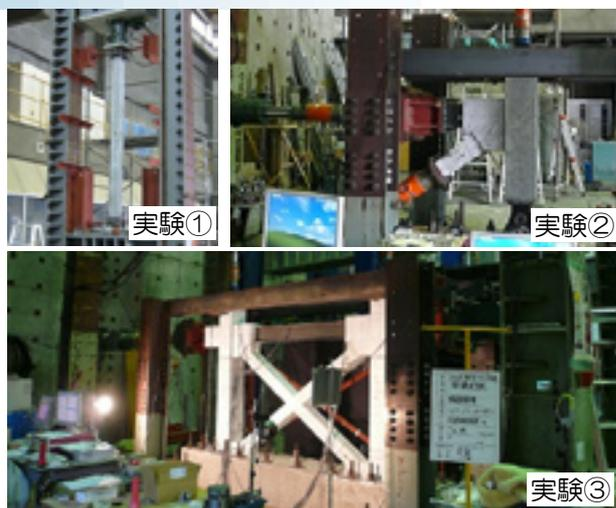
図-2 RC ブレースの各種加力実験
