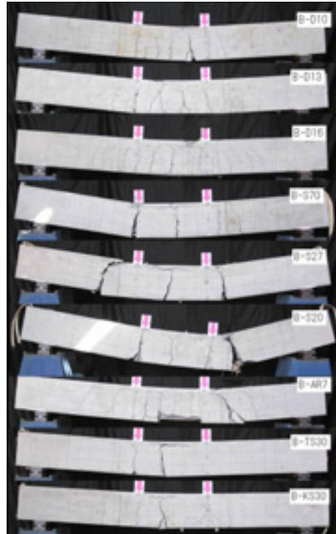
写真-2 曲げ試験体ひび割れ形状
