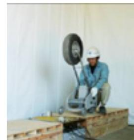
写真-2 衝撃源の加振力測定状況
