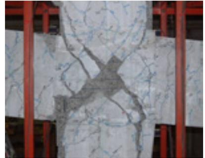
図-6 最終破壊状況 ( R=1/10 rad )
