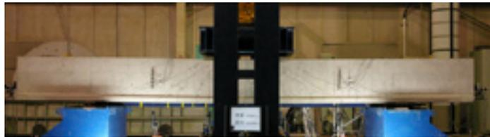
写真-2 PC はりの载荷試験
