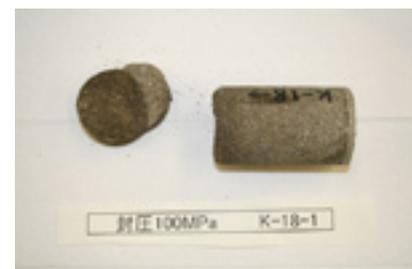
写真-3 破壊後の岩石供試体状況
