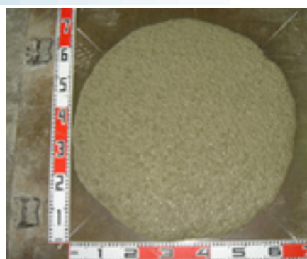
写真-1 高流動軽量コンクリートのスランプフロー試験の状況
