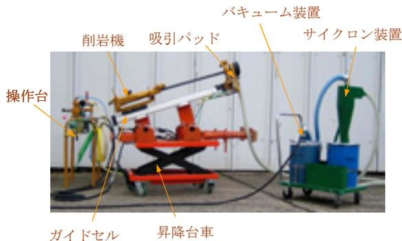
写真-2 削孔システムの構成
