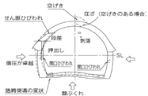
(a) 外力によるトンネル変状の種類
