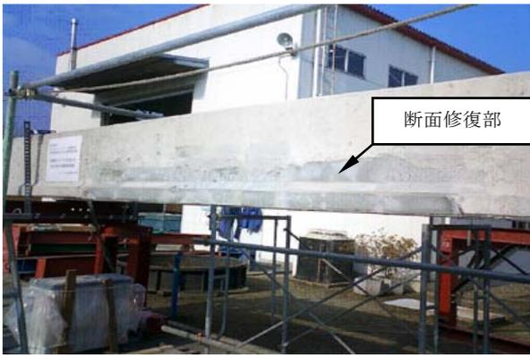
写真-3 塩害劣化を想定したPC桁の断面修復実験において、低収縮型高強度高流動コンクリートにより断面修復を行った状況<sup>8)</sup>
