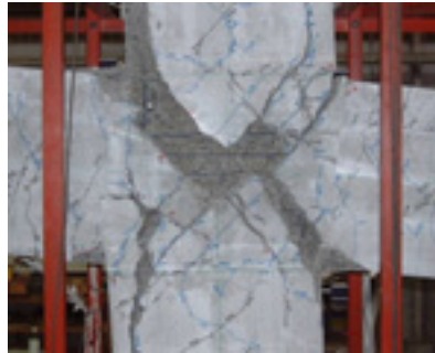
図-6 最終破壊状況 ( R=1/10 rad )
