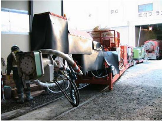
写真-3 遠心カトンネル吹付け機の列車編成
