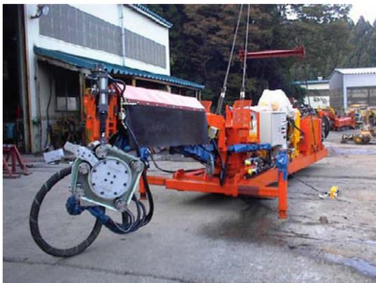
写真-1 遠心力トンネル吹付け機
