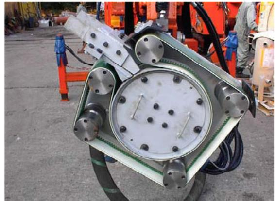
写真-2 遠心力トンネル吹付け装置
