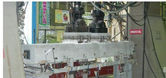
写真-1 疲労载荷試験
