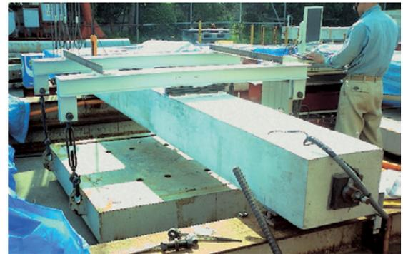
写真-2 持続荷重載荷試験
