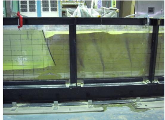
写真-5 模型地盤の変形状況（無改良（CASE5：500Gal加振後））
