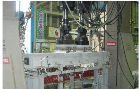
写真-1 疲労載荷試験
