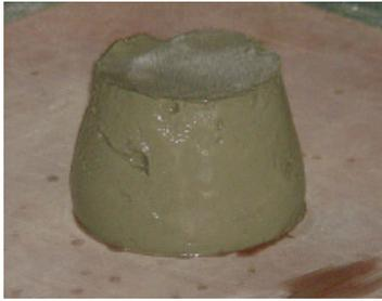
写真-1 静止フロー試験状況 (D=98mm)
