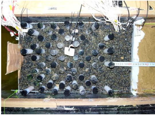
写真-3 改良体模型の配置状況（1軸改良）
