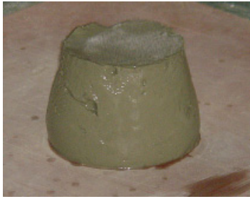
写真-1 静止フロー試験状況 (D=98mm)
