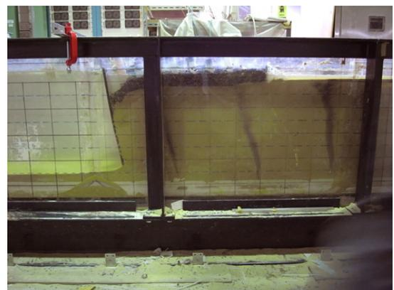
写真-6 模型地盤の変形状況（1軸改良（CASE6：500Gal加振後））
