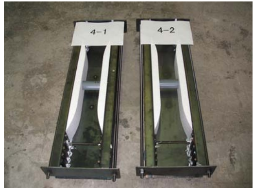
写真-1 型枠およびひび割れ誘発材設置状況
