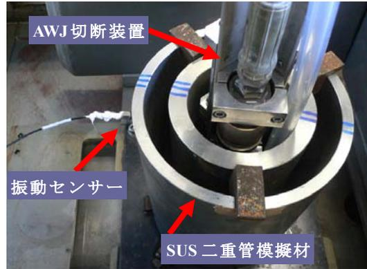
写真-7 振動センサー設置状況
