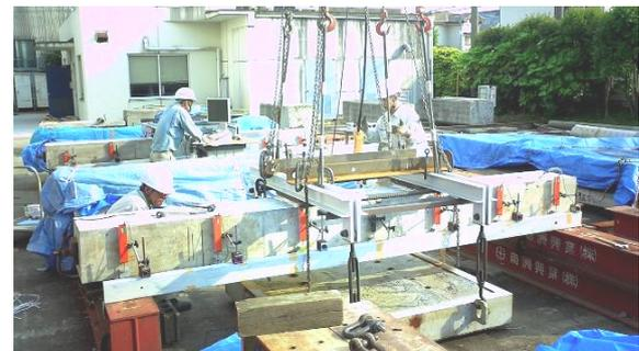
写真-1 持続荷重載荷試験
