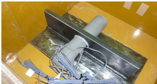
写真-1 コンクリートジベル配置
