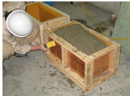
写真-1 試験体と水分計測定状況
